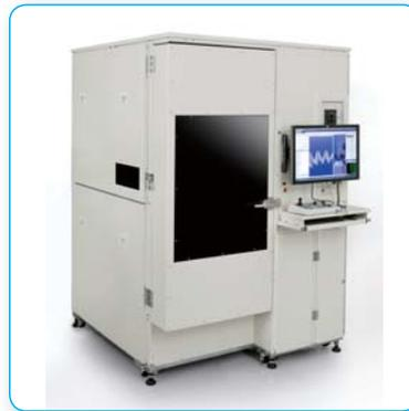
小モジュール・小型歯車の検査にはニコン社製 高精度非接触センサー 3D システム「HN-C3030P」を採用しています。
